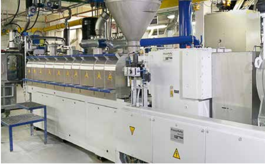
Die neueste Compoundieranlage von PolyComp (ZE65x50D der Baureihe ZE BluePower, Hersteller: KraussMaffei Berstorff GmbH) wurde im 1. Quartal 2018 installiert (© PolyComp)
