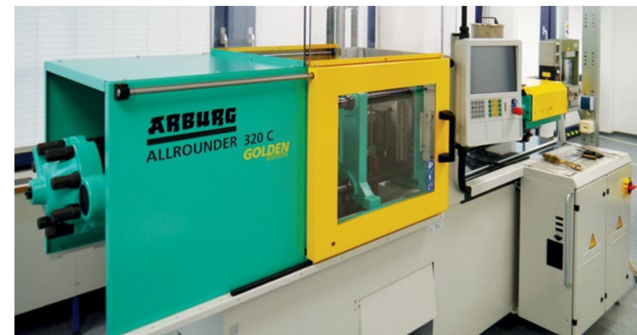
Für Kundenversuche steht eine moderne Spritzgussmaschine mit 500 kN Schließkraft zur Verfügung.
